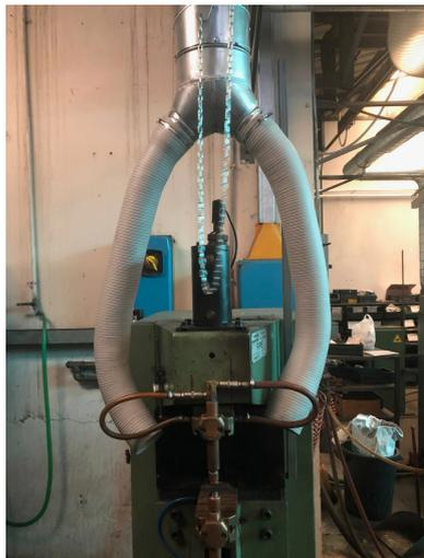
**Tubo flessibile** grigio chiaro in robusto **PVC**, spiralato in elicoide, grazie al materiale ed alla costruzione rimane in posizione "sospeso" autoportante, caratteristica unica e molto utile nei tratti terminali degli impianti di aspirazione come ad esempio nella fotografia sotto ricavata da un'applicazione di aspirazione fumi di puntatura.
