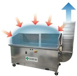
S'il est équipé de roues pour la manipulation et d'un silencieux pour l'évacuation de l'air ambiant, il devient un instrument très flexible en production, **complètement indépendant** sans avoir besoin de connecter une cheminée pour l'expulsion dans l'atmosphère.
