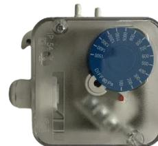
Kit pressostato differenziale range 100-1500 Pa completo di n.2 prese pressione, viti di fissaggio e 2mt di tubo PVC.
