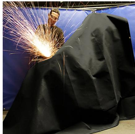
Couverture modèle BASIC composée de fibre de verre et de polyuréthane sur une face, qui a pour seule fonction de maintenir la fibre de verre qui, autrement, s'effiloche facilement. Cette série est recommandée pour la protection verticale en prévision d'un faible niveau d'étincelles et d'éclaboussures.
