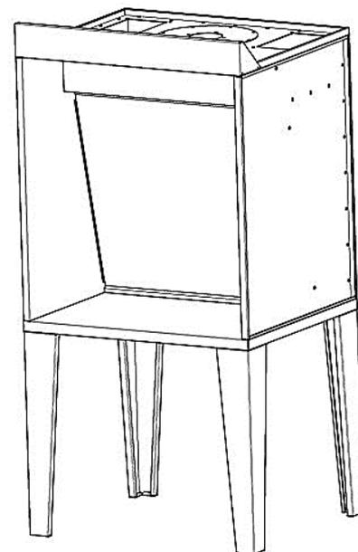
Figura 2 - Cabina di verniciatura MFP 10-15-18
