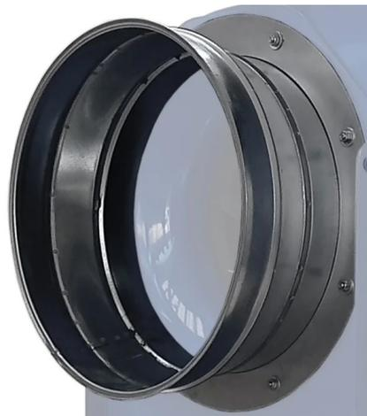
Raccord d'aspiration circulaire pour ventilateurs SVM-R-F en acier galvanisé, équipé d'une bride avec des trous pour la fixation à l'entrée du ventilateur et d'un bourrelet préparée pour le collier du côté de la fixation de la tuyauterie du système.
