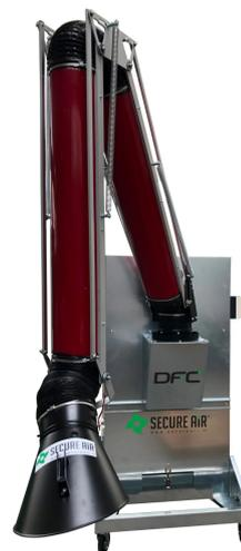
L'aspiratore di polveri e fumi mobile DFC11 con filtri autopulenti è la soluzione ideale per l'aspirazione e la filtrazione dei fumi e delle micro-polveri generate durante i processi di trattamento superficiale dei metalli o dei materiali compositi.
