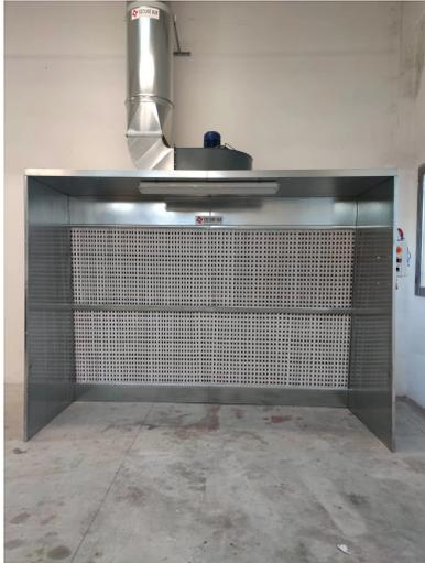
Esempio di installazione cabina di verniciatura con prolunghe e tetto, collegata a camino di espulsione.
