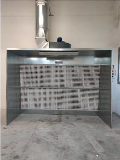
Exemple d'installation de cabine de pulvérisation avec extensions et toit, avec éclairage et panneau de commande (WFPX)
