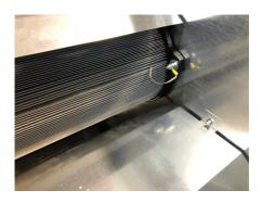
Kit de filtre HEPA H13 antistatique de remplacement pour les bancs SBCX.
