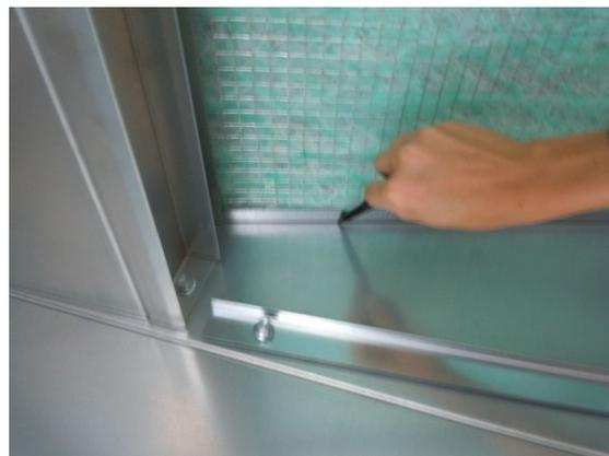
Figura 11 - Allineamento Paint Stop
