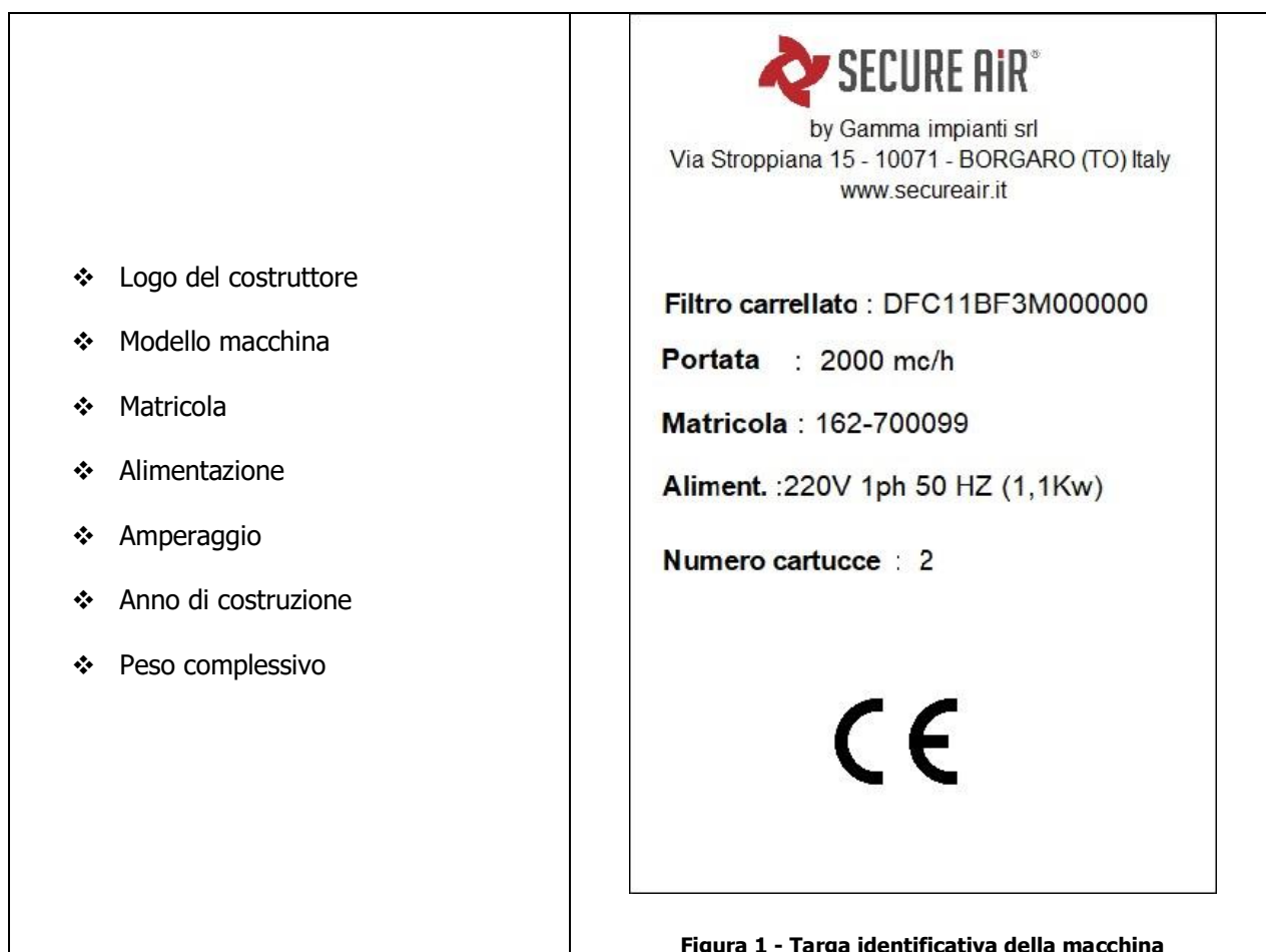
Figura 1 - Targa identificativa della macchina
