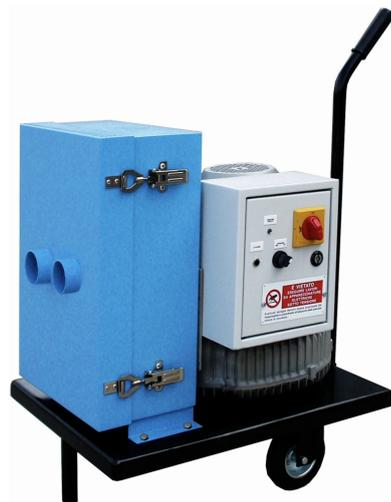
Aspirateur haute pression ESAT, à connecter à 2 torches aspirantes maximum de la ligne SAT, spécialement conçu pour un usage industriel en fonctionnement continu (cycle de travail de 100%) grâce à la robuste soufflante/turbine en aluminium avec moteur triphasé. Monté sur un chariot à roulettes.
