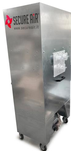
L'aspiratore di polveri e fumi mobile DFC11 con filtri autopulenti è la soluzione ideale per l'aspirazione e la filtrazione dei fumi e delle micro-polveri generate durante i processi di trattamento superficiale dei metalli o dei materiali compositi.
