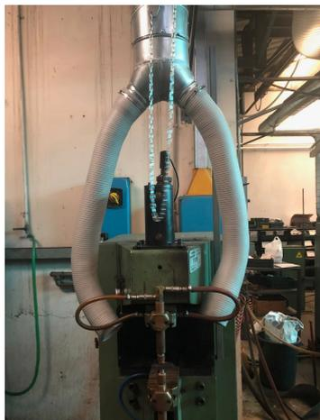
**Tuyau flexible** gris clair en **PVC** robuste, spiralé de manière hélicoïdale. Grâce au matériau et à la construction, il reste en position autoportante "suspendue", une caractéristique unique et très utile dans les sections d'extrémité des systèmes d'aspiration, comme par exemple sur la photo ci-dessous prise dans une application d'aspiration de fumées de pointage.
