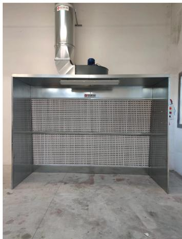
Exemple d'installation de cabine de pulvérisation avec des extensions et un toit, relié à une cheminée d'expulsion.
