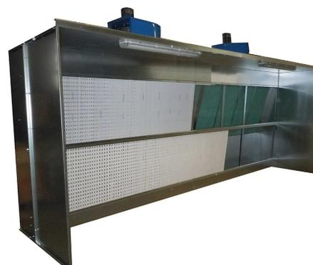
Les **cabines de peinture sèche WFPL** en version murale sont équipées de filtres et d'unités d'aspiration intégrés et, grâce à leur géométrie, forment un front d'aspiration à vitesse constante afin de capturer les fumées produites par des opérations telles que la peinture, le revêtement de résine, le collage et tous les traitements professionnels qui génèrent des fumées non poussiéreuses et de l'overspray.
