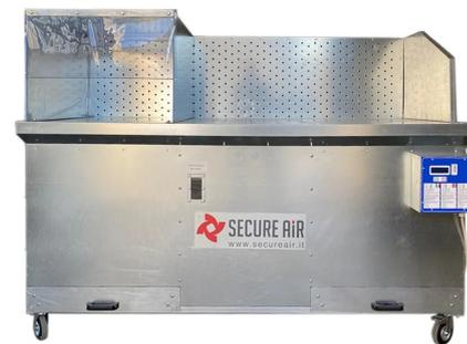
Il **banco aspirante SBP** è da utilizzare per aspirare le polveri generate durante le operazioni di pulizia e soffiaggio pezzi con aria compressa, per evitare che vengano respirate dagli operatori e che inquinino l'ambiente di lavoro, in quanto molto volatili.
