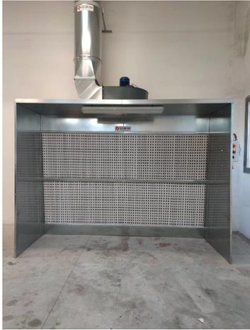
Esempio di installazione cabina di verniciatura con prolunghe e tetto, in versione completa di luci e quadro elettrico (WFPX)
