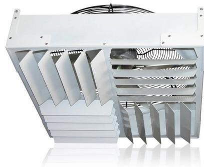
I destratificatori ASTRA **aumentano l'efficienza dell'impianto di riscaldamento** prevenendo l'accumulo di aria calda nelle parti alte degli edifici. Il ventilatore reindirizza il calore verso il basso, riducendo così le dispersioni termiche ed evitando la dispersione di calore verso l'esterno.
