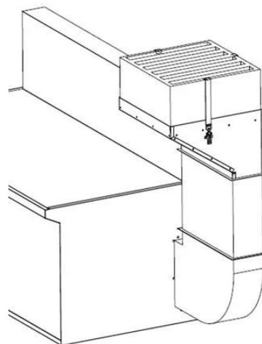
Kit d'aspiration avec filtre HEPA 13 intégré compatible avec les banques SBV.
