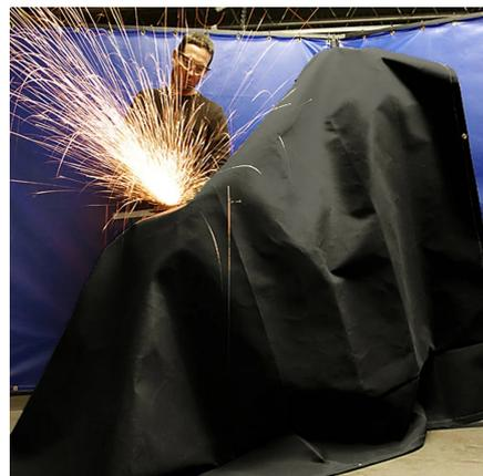
La couverture de la série TOP est recommandée pour la protection horizontale et, par conséquent, les matériaux incandescents peuvent tomber et se refroidir sur elle sans la perforer. En effet, Thetis pèse 1100gr/m<sup>2</sup> et a une épaisseur de 1,4mm. Elle subit également un traitement à base de graphite sur les deux faces (présent en noir) qui augmente la température de résistance jusqu'à 700°C avec des pointes pour de courtes périodes jusqu'à 900°C.
