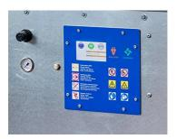
Panneau opérateur situé sur la face avant du banc d'aspiration
